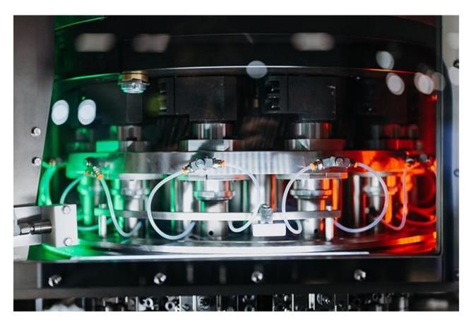
Es gab Einblicke in die vollautomatische und Temperaturüberwachte Zweikreis-Ölumlaufschmierung der neuen Zacmi Dosenverschließmaschine.
