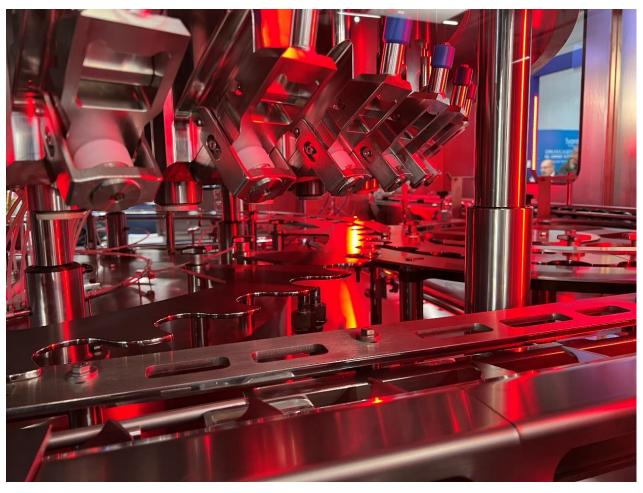
> ZACMI Füllmaschine im Clean Design mit vollständiger CIP Option und innovativen Abfülltechnologien.
